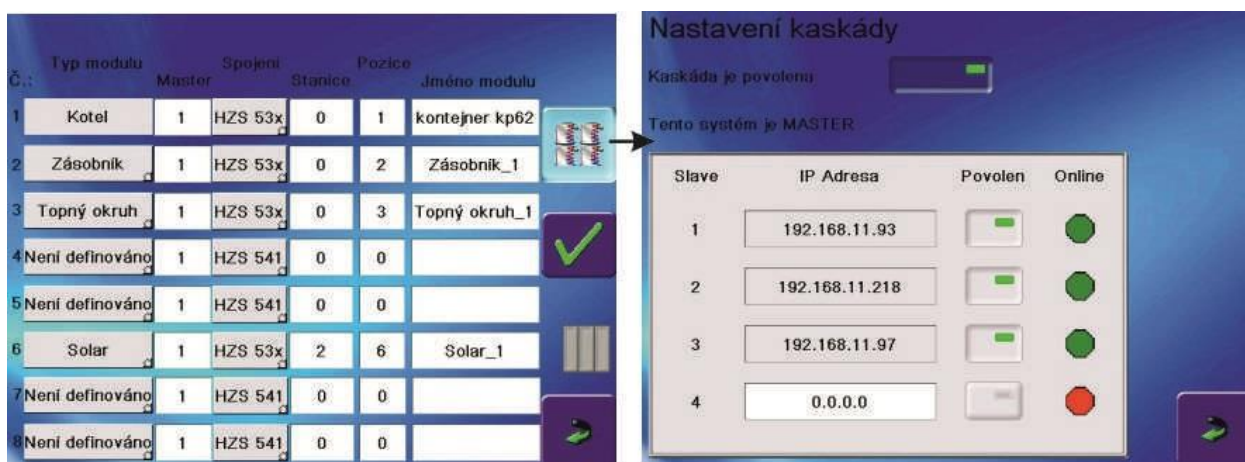
Povolení kaskády, nastavení na MASTER a zadání IP adres podřízených kotlů (SLAVE)
