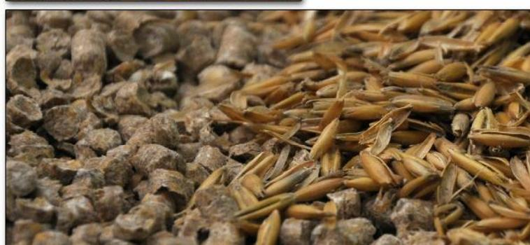
Palivo pro průmyslový kotel VERNER GOLEM se vyrábí z odpadů z výroby.
